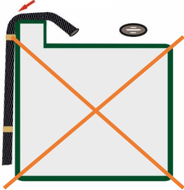
Querschnittsverengung an Dachkante
