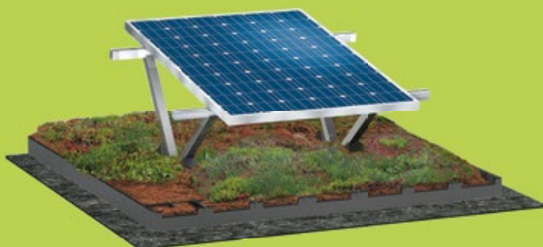
Kombinationsnutzdach PV-Dachbegrünung Quelle: Bauder
